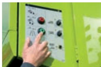
Для сброса соломы измельчитель регулируется нажатием кнопки с помощью электрогидравлической системы.
