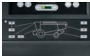
Наглядное и простое управление рабочим освещением возможно с помощью панели управления. Настройку конфигурации фар можно быстро выполнить в CEBIS.
