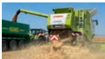
Благодаря эффективной верхней выгрузке из бункера можно выгружать до 110 л зерна в секунду.
